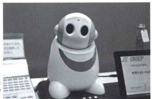
自社開発の癒し系受付代行ロボット・システム「SERAPIS(セラピス)」。お客さまをあいさつで迎え、受付担当には来客を知らせてくれる
